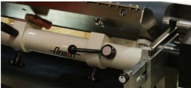
**Légèreté des chambres et sortie de l'encrage sans outillage** - Simplification de la manutention et de la maintenance.
