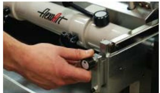
**Aucune fausse manœuvre** - grâce aux réglages pré-définis. Réajustement 1 ou 2 fois par équipe.
